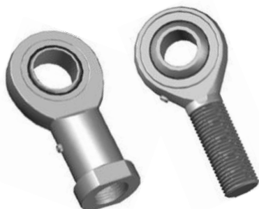
Embouts à rotule EXPI..VW, EXPE..VW Acier/Bronze Bague extérieure avec revêtement en bronze, corps d'embout avec trou de lubrification ou graisseur, avec filetage à droite ou à gauche dans la version mâle ou femelle.
