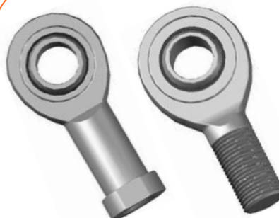
Embouts à rotule EXZI..PV, EXZE..PV Acier/Teflon Sans lubrification, produit avec insert en nylon/teflon/fibre de verre, corps d'embout avec filetage à droite ou à gauche dans la version mâle ou femelle.
