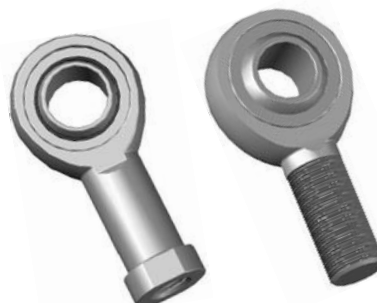
Embouts à rotule SS EXTI..VW , SS EXTE..VW Acier inox./PTFE produit avec jointes à rotule radiale sans entretien et corps d'embout avec filetage à droite ou à gauche dans la version mâle ou femelle.
