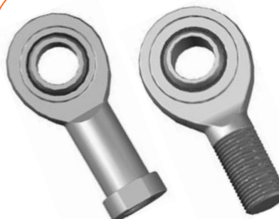
Teste snodo EXZI..PV, EXZE..PV Acciaio/Teflon Senza rilubrificazione, testa snodo con inserto in materiale composito con filetto destro o sinistro nella versione maschio o femmina.
