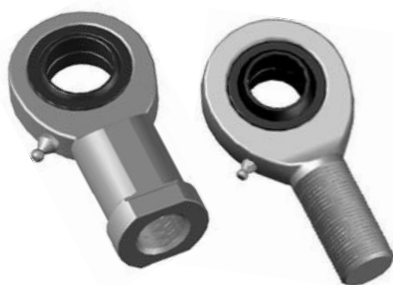
Teste snodo EXHI..DO (2RS), EXHE..DO (2RS) Acciaio/Acciaio realizzato con snodo sferico radiale BJ..E o BJ..E 2RS e teste snodo con filetto destro o sinistro nella versione maschio o femmina.
